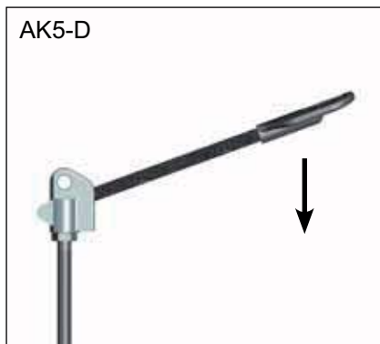
AK5-D Auslösehebel (Auslöserichtung hin zur Feder) Auslösekopf, Hebel, Flachgriff
